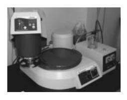
セラミック材料や金属材料などの硬質材料の組織観察や物性試験に必要な鏡面加工を行う装置です。加工可能な最大試料寸法は、直径約20mm、高さ約10mmで、あらかじめ樹脂埋めしておく必要があります。
