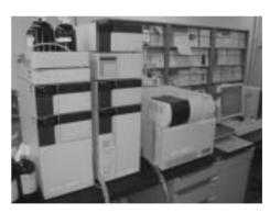
従来から導入済の、低・高沸点にかかわらず広く有機化合物を高感度で測定可能なLC MS(液体クロマトグラフ・マススペクトロメーター、島津LCMSー2010EV)の検出器として新たにRID(示差屈折検出器)を追加しました。このLCMSはHPLC(高速液体クロマトグラフ)単独でも使用可能なため、HPLCーRIDによる糖の定性・定量分析も出来るようになりました。特に食品分野の受託研究・共同研究等で利用可能です。
