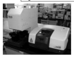
本機は各種有機材料を顕微鏡観察しながら 赤外吸収スペクトルを測定し、種類の判別や 構造の推定(定性)に用いる装置で、特に表面 の分析や微小異物の分析に有効です。また試 料の広範囲な領域の化学組成を解析するた めに有効なマッピング測定を高速で行えるよ うにマルチチャンネル検出器を装備しています。 お問い合せ:繊維:高分子技術チーム
