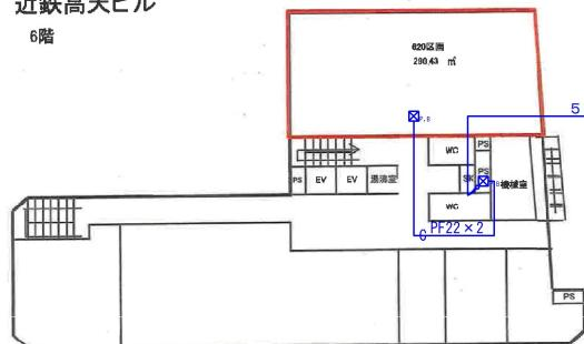
テナント分電盤内AC100V 20Aを単独専用回路にて供給
