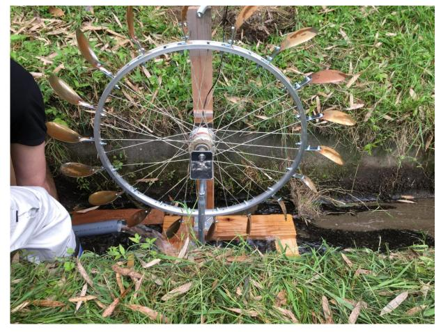
流量による回転数が得ら れる形状の水車での 必要な台数等を検討中 様々な形状の水車 回路(普通電圧・倍電圧)
