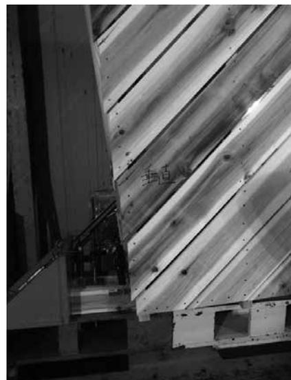
(d) 最終破壊時の野地板の隙間と釘打ち部の割裂破壊
