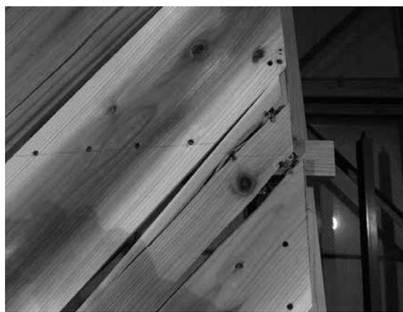
(d) 最終破壊時の野地板の隙間と釘打ち部の割裂破壊
