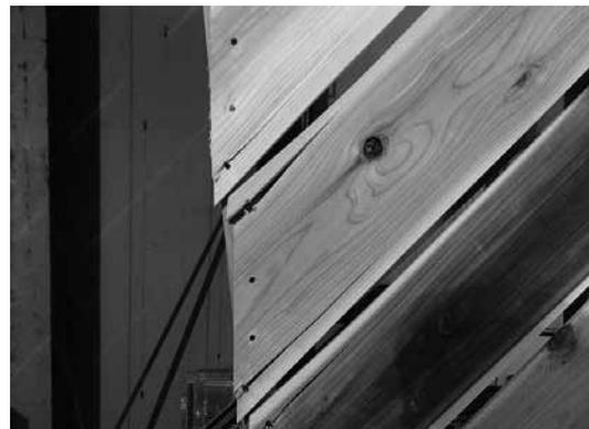
(d) 最終破壊時の野地板の隙間と釘打ち部の割裂破壊
