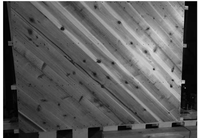
(d) 最終破壊時の野地板の様子
