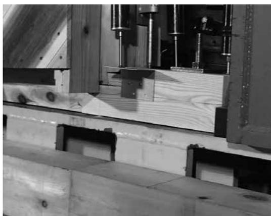
(c) 下部母屋と梁との接合部での破壊
