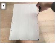
7) eを本体前面に取り付ける。 yでhを対角の順にねじ込む。 本体とのすき間が無くなればOK。 x を代用する場合は、締めすぎに注意。 (締めすぎると e が破損します。) 高音部である天側左右の角はネジ不要です。
