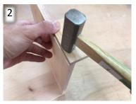
2) cのホゾをa、bの溝に入れる。 c の内外を確認し、両端を合わせる。 手で押し込んで入らない場合は、kの上 からwで叩く。 外したい場合は、wでa(またはb)の 裏側を軽く叩く。
