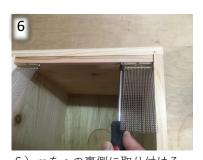
6) mをaの裏側に取り付ける。 iとyを使用する。 eを仮に当て、eとmをわずかに離す。 (Imm程度) eとmが触れていたり、離れすぎている と音が悪くなります。
