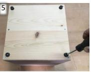
5) bにjを取り付ける。 gとyを使用する。 」が指で動かなくなればOK。 x を代用する場合は、締めすぎに注意。 (締めすぎるとjが破損します。)
