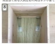
8) mの響きを調整する。 打面(e)を表からたたいて音を確認する。 針金の響きを抑えたいときは、テープ等 でeに固定する。
