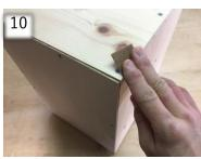
10) n で角や縁を研磨する。 触れたとき痛くないように、端やサウ ンドホールの角ばりをなだらかにする。 n の強度を保つため、三つ折りでの使用 を推奨します。
