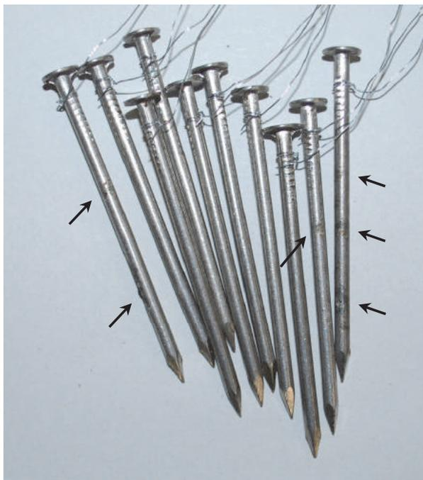
図9 高温条件下で18週間放置したAAC-1処理試験体から取り出したSFくぎの状態
