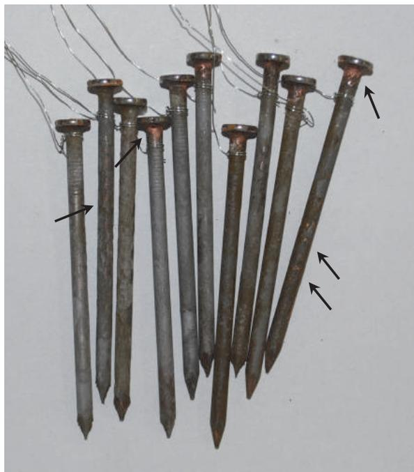
図10 水濡れ条件下で1.5年間放置したCUAZ処理試験体から取り出したCNくぎの状態
