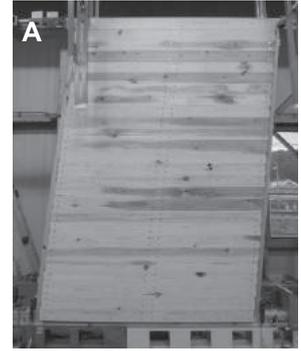
厚板:桁行方向、木ダボ:9.5mm
