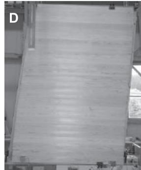
厚板:桁行方向、木ダボ:21mm
