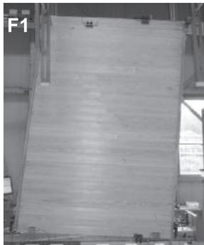
厚板:桁行方向、木ダボ:21mm
