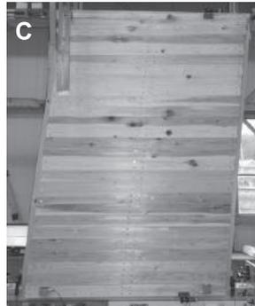
厚板:桁行方向、木ダボ:21mm
