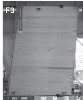
厚板:桁行方向、木ダボ:21mm
