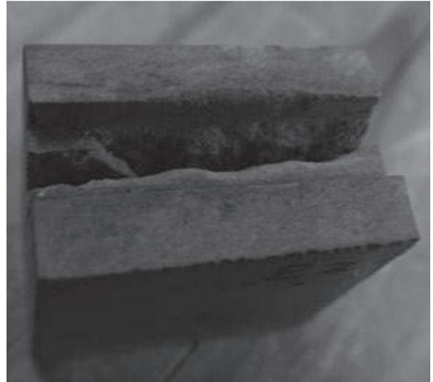
図5 85%切断面溝有りの試験体に発生した亀裂と摂食状況
