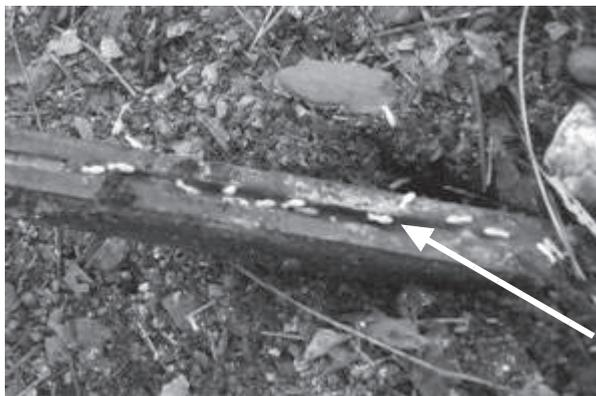
図8 野外試験2週間後の試験体側面の溝部分に集合したイエシロアリ（図中の矢印）
