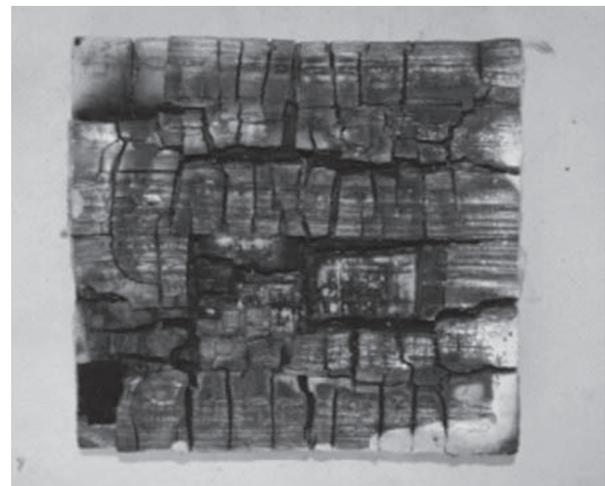
図5 耐火試験後の試験体(表3 No1)
