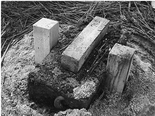
図6 野外防蟻性能試験における改良クレオソート油で表面処理した試験体の試験終了時の様子
