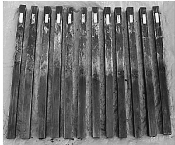
図1 野外防蟻性能試験における改良クレオソート油の注入処理杭（設置後6年経過時）
