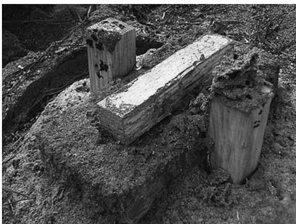
図7 野外防蟻性能試験における無処理試験体の試験終了時の様子
